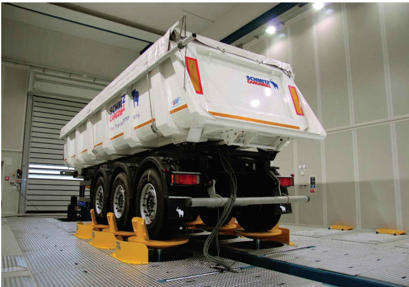
Stalowe podwozie przeszło wyczerpujące testy na stanowisku pomiarowym
