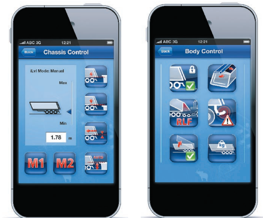
Funkcje kontroli naczepy- zabudowy i podwozia dostępne są z poziomu smartfona po wgraniu stosownej aplikacji
