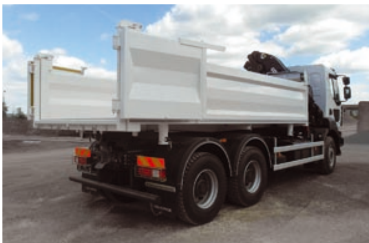
Tylna burta może być wykonana w formie klapo-drzwi umożliwiających wygodny transport długich ładunków
