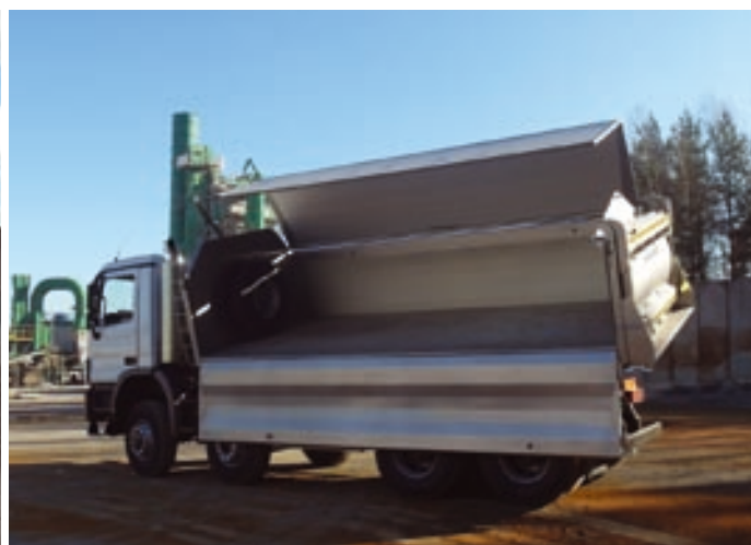
Hydrauliczny dach zamontowany na życzenie klienta chroni ładunek przed niekorzystnym wpływem warunków atmosferycznych
