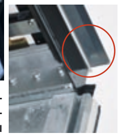
W dachu naczepy zamontowano okap, uniemożliwiający zalewanie ładunku
